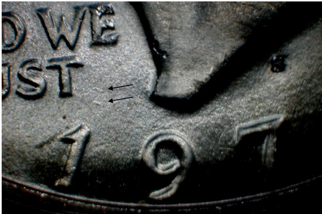
“ORIGINAL” 71-S SB FS-501 S/S RPM SHOWING MARKER NAKED-EYE DIE GOUGES
